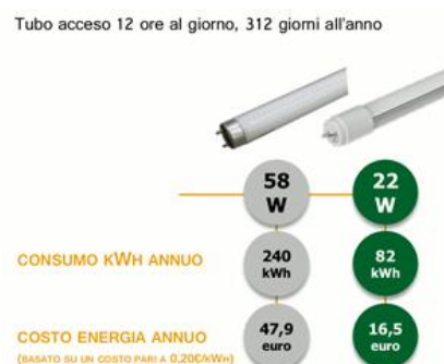
Figura 8.6 – Esempio comparativo lampade neon e LED
