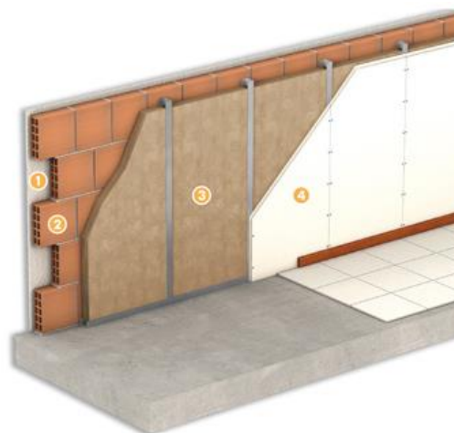
Figura 8.3 – Particolare composizione cappotto interno
